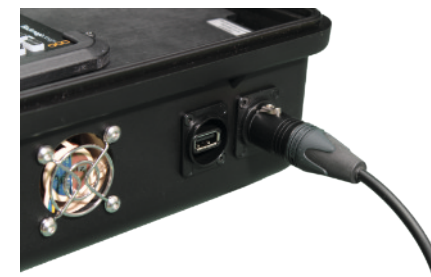
(Figure 20) Case BSS Connexion de la batterie
