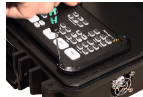
(Fig. 14) Atornille el ATEM Mini con abrazaderas en C
