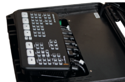
(Figure 13) Pivoter l'ATEM Mini vers l'intérieur
