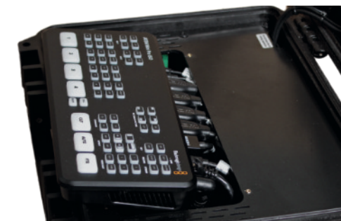
(Bild 13) ATEM Mini einschwenken
