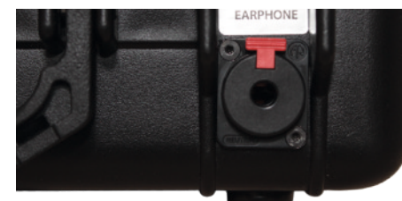
(Bild 18) 6,35mm Kopfhörerbuchse
