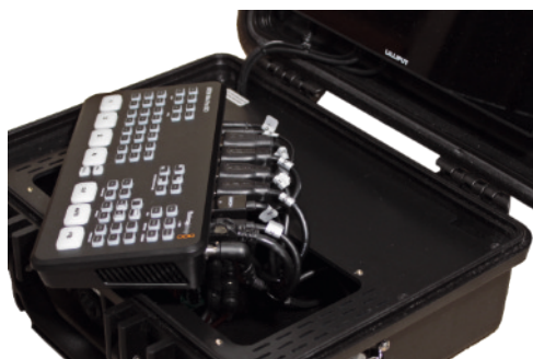
(Fig. 12) Inserire il cavo sull'ATEM Mini
