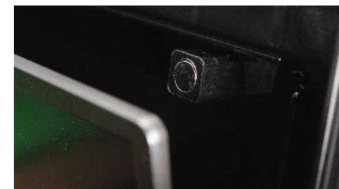
(Fig. 23) Monitor staccato dal supporto magnetico
