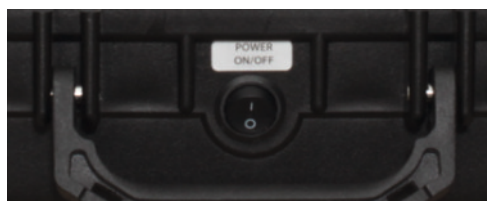
(Figure 15) Interrupteur marche/arrêt sur la face avant.
