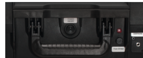
(Fig. 21) LED y fusible en la parte frontal de una carcasa para ATEM Extreme
