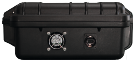
(Fig. 19) Custodia del BSS Presa di ricarica USB
