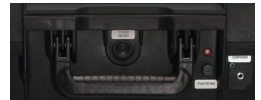
(Fig. 21) LED e fusibile sulla parte anteriore della custodia per ATEM Extreme
