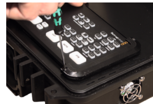
(Figure 14) Visser l'ATEM Mini avec des tendeurs en C
