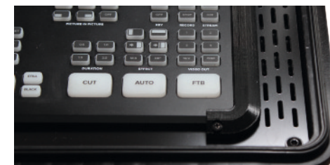
(Fig. 16) Fessure di ventilazione della cassa del BSS
