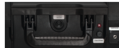
(Figure 21) LED & fusible sur la face avant d'un boîtier pour ATEM Extreme
