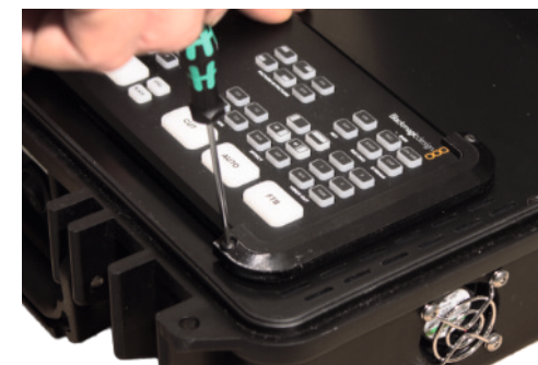
(Fig. 14) Avvitare l'ATEM Mini con morsetti a C
