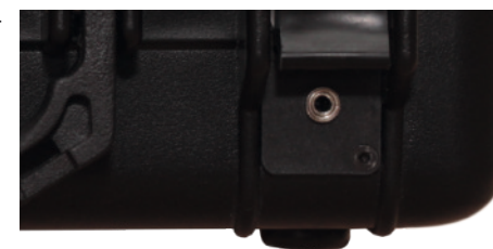
(Bild 17) 3,5mm Kopfhörerbuchse
