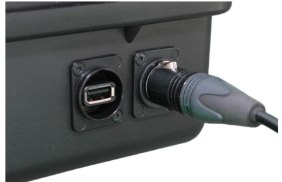
Case mit gestecktem Batterieanschlussstecker (XLR-4-polig Female Ausführung)
