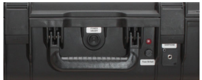
LED & Sicherung der Batteriespeisung an der Frontseite eines Case für ATEM Extreme
