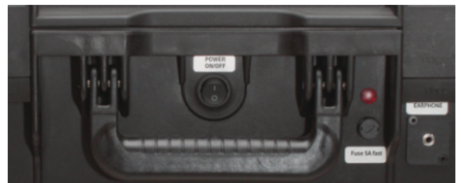
LED et fusible de l'alimentation par batterie sur la face avant d'un boîtier pour ATEM Extreme
