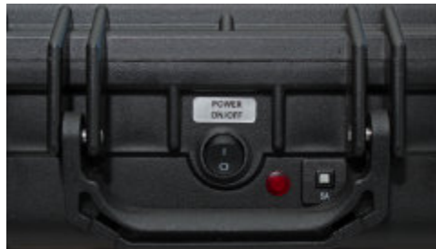
(Bild 21) LED & Sicherung der Batteriespeisung an der Frontseite
