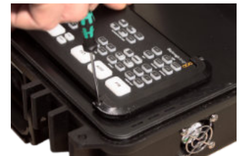
(Bild 14) ATEM Mini mit C-Spannern verschrauben
