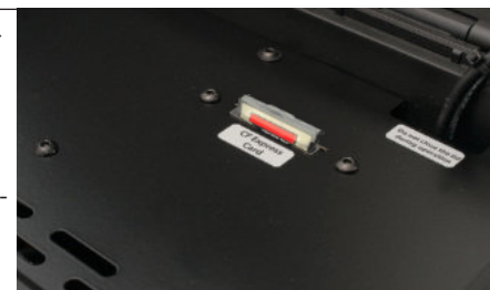
(Imagen 22) Tarjeta CFexpress en la ranura integrada en la placa superior de la maleta BSS
