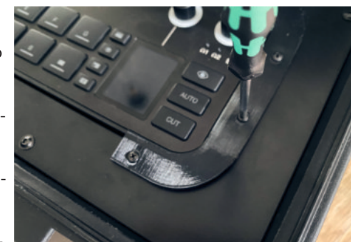
(Immagine 15) Fissare il C-Spanner nel case del ATEM Extreme G2
