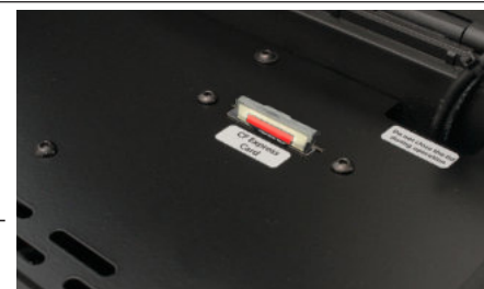
(Immagine 22) Scheda CFexpress nello slot integrato sulla piastra superiore del BSS-Case
