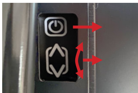
(Imagen 20) Elementos de control y acceso en el lado izquierdo del monitor
