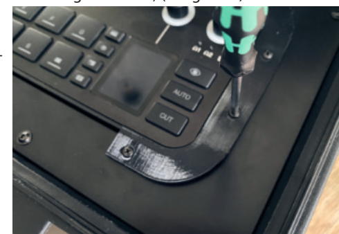
(Imagen 15) Atornillado de las abrazaderas en C en el maletín del ATEM Extreme G2.
