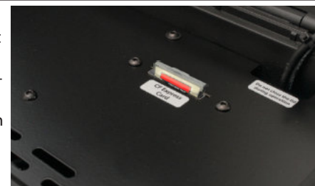
(Bild 22) Cfexpresskarte im Einbauschacht auf der Deckplatte des BSS-Cases
