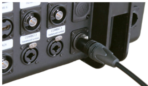
(Bild 24) BSS-Case Batterieanschluss mit angestecktem Adapterkabel
