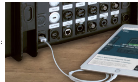
(Bild 23) USB-Ladebuchse mit eingestecktem zu ladendem Gerät
