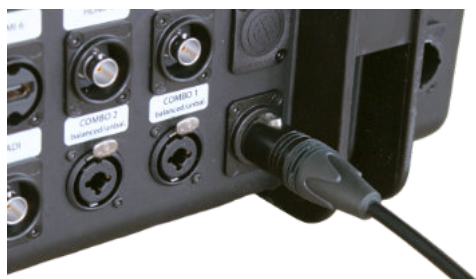
(Immagine 24) Collegamento batteria del BSS-Case con cavo adattatore inserito
