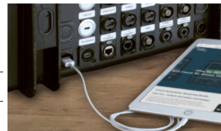
(Immagine 23) USB-Ladebuchse mit eingestecktem zu ladenden Gerät
