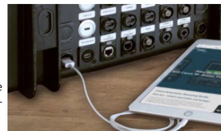
(Imagen 23) USB-Ladebuchse mit eingestecktem zu ladenden Gerät
