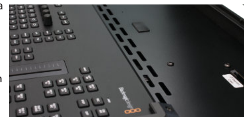
(Immagine 19) Fessure di ventilazione del BSS-Case
