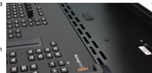
(Immagine 19) Fessure di ventilazione del BSS-Case
