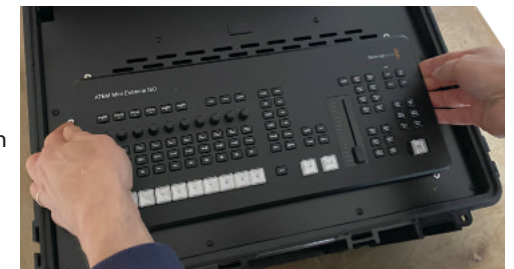
(Bild 16) Entnahme des ATEM Extreme G2
