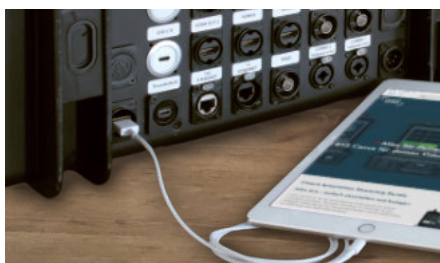
(Figure 23) Port de charge USB avec appareil en cours de charge branché
