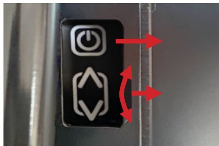
(Immagine 20) Elementi di controllo e accesso sul lato sinistro del monitor
