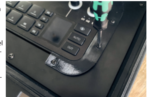
(Imagen 15) Atornillado de las abrazaderas en C en el maletín del ATEM Extreme G2.
