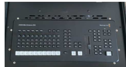
(Figure 14) ATEM Extreme G2 correctement mis en place
