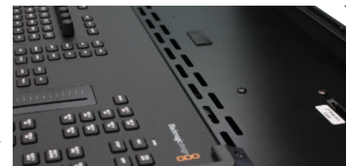
(Figure 19) Fentes de ventilation du boîtier BSS
