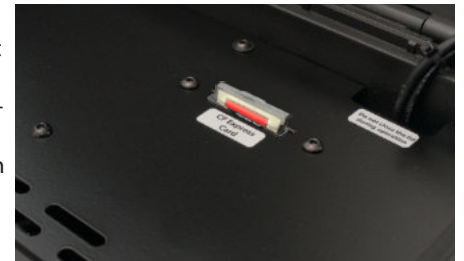
(Bild 22) Cfexpresskarte im Einbauschacht auf der Deckplatte des BSS-Cases
