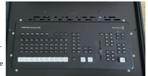
(Imagen 14) ATEM Extreme G2 correctamente insertado
