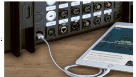
(Bild 23) USB-Ladebuchse mit eingestecktem zu ladendem Gerät
