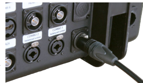
(Figure 24) Connecteur batterie BSS et son câble adaptateur
