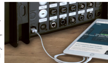
(Immagine 23) USB-Ladebuchse mit eingestecktem zu ladenden Gerät
