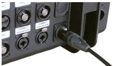
(Imagen 24) Conexión de batería de la maleta BSS con cable adaptador conectado
