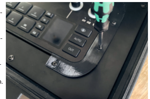
(Immagine 15) Fissare il C-Spanner nel case del ATEM Extreme G2
