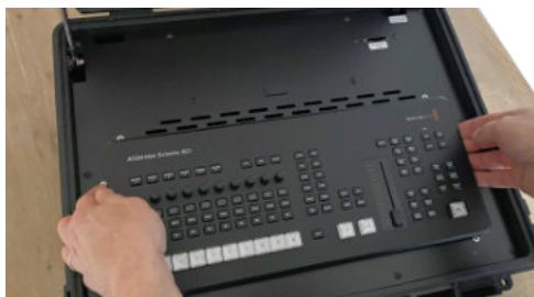
(Imagen 16) Desmontaje del ATEM Extreme G2
