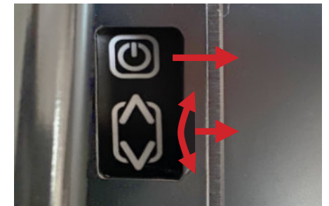
(Bild 20) Zugang zu den Bedienelementen auf der linken Monitorseite
