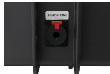
(Figure 21) Prise casque 6,35 mm sur la face avant du boîtier
