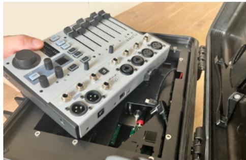
(Fig. 1) Insert Flow 8
