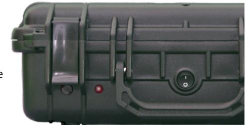
(Bild 19) Batterieanschluss - Sicherung auf Frontseite mit Kontroll-LED
