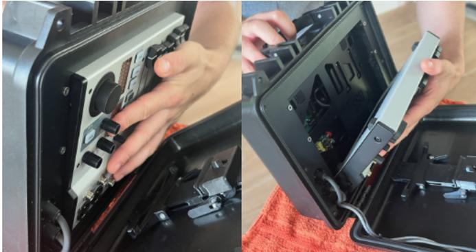
(Bild 5) Flow 8 entnehmen; das Case auf weicher Unterlage abkippen und das Flow 8 mit einer Hand gegen herauskippen halten
