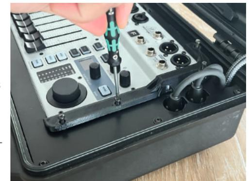
(Bild 4) Flow 8 Spanner verschrauben
