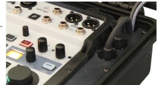
(Bild 16) XLR-Stecker und Kabel in Parkposition im Case
