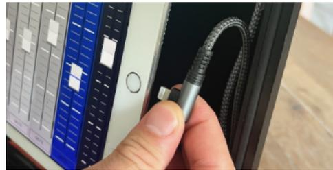
(Bild 10) Ladekabel einstecken, bei wenig Platz zum Deckelrand um 180° verdreht
