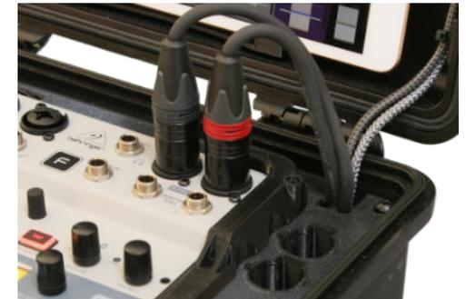
(Bild 15) XLR-Stecker und Kabel gesteckt im Flow 8 Main Out
