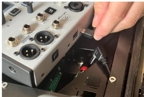
(Bild 2) USB Spannungsversorgung einstecken
