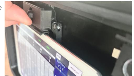
(Bild 7) Oberen Halter auf richtigen Abstand anpassen und Druckstück anlegen
