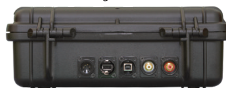
BSS-Flow 8 Case Rückseite mit den Optionen: Batterieanschluss, USB-A La- debuchse und Cinch-R/L-Ausgang
