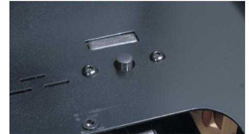
(Bild 26) MicroSD-Kartenschacht (mit Abdeckung) auf der Deckplatte
