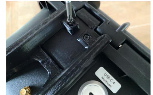
(Bild 19) Antennenschutz verschrauben
