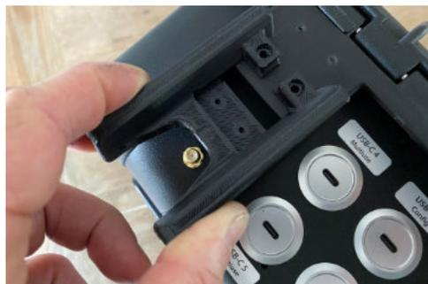
(Bild 18) Antennenschutz in die vorgesehene Tasche schieben
