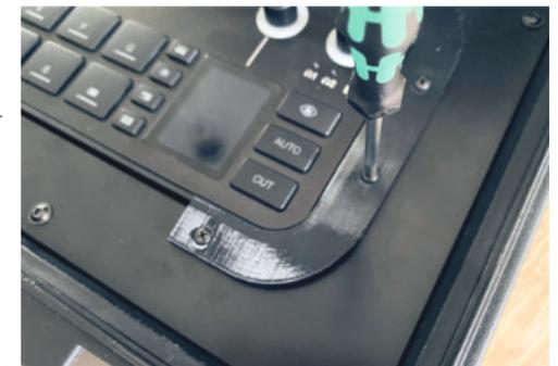
(Bild 15) C-Spanner im Rodecaster Video Case verschrauben
