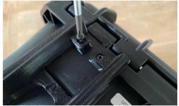
Visser le protège-antenne avec des vis de 3x10mm (outil nécessaire : tournevis cruciforme taille 01)
