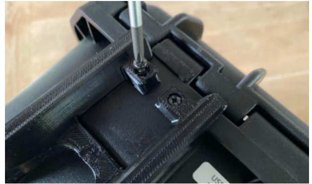
Verschrauben des Antennenschutzes mit 3x10mm Schrauben (benötigtes Werkzeug Kreuzschlitzschraubendreher Größe 01)
