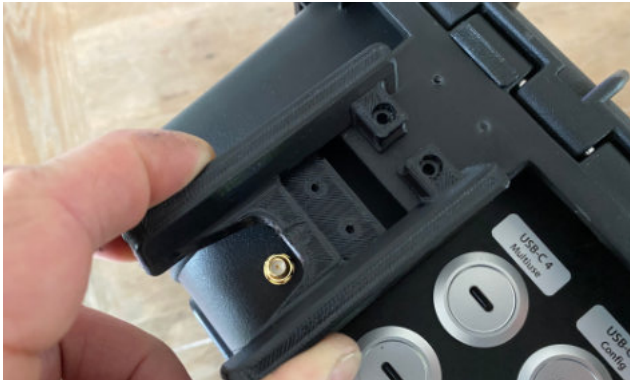
Einsetzen des Antennenschutzes an der Formtasche auf der Rückseite des Cases
