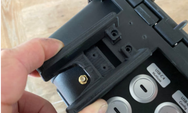
Insertion du protège-antenne dans la poche moulée à l'arrière de la coque
